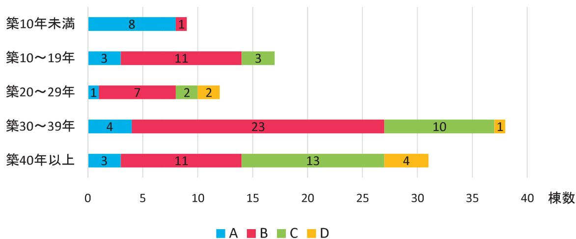
築30年を超えると、C評価の棟数が増加します。外壁に使われている木材の色落ちや腐食、また、ひびや浮きが多く見受けられます。外壁のひびから雨漏りをしている学校もあります。
