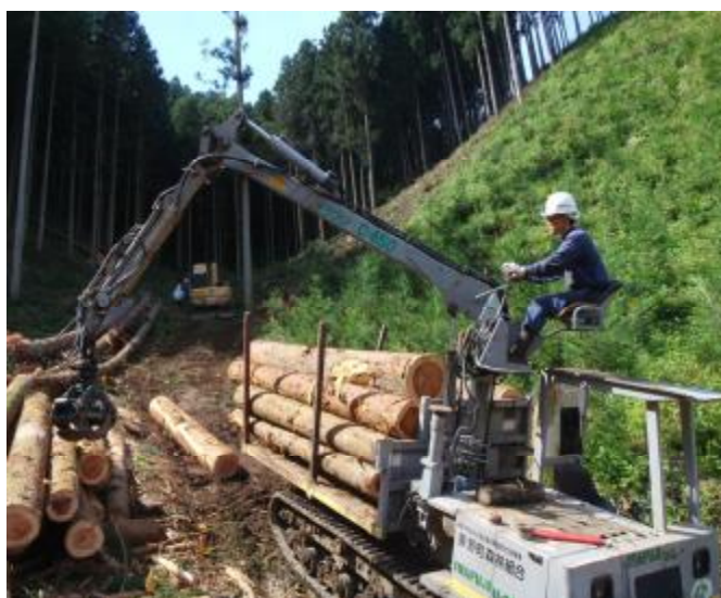
林業機械を利用した運材作業
