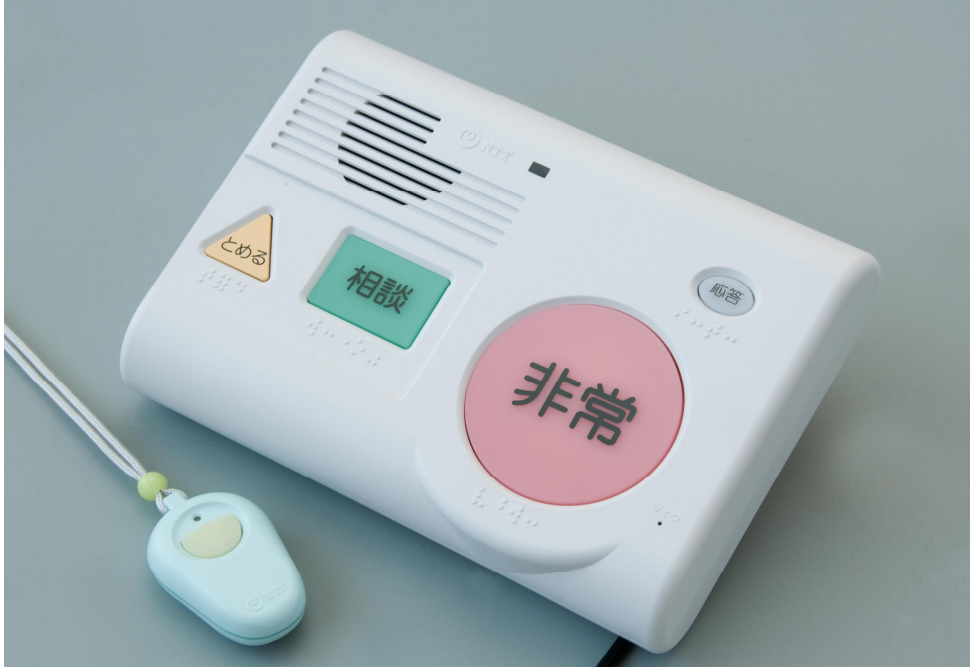
緊急通報装置(固定型)
