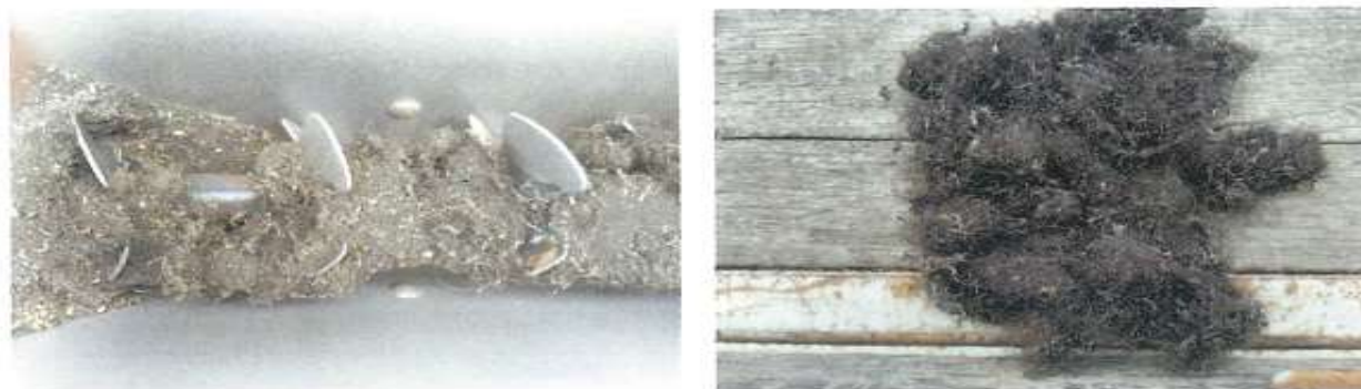
写真 1-7 汚泥肥料散布時に発生した髪の毛による詰まり
