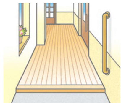
廊下幅の確保
