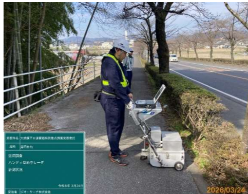
図5 空洞調査状況写真 (歩道部)
